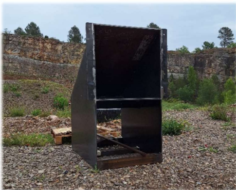
Figure 3 : Piège à balles au pas de tir à 100 mètres
